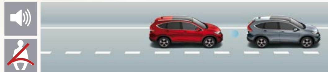
Четвертый этап: система торможения активирует преднатяжитель водительского ремня безопасности, который затягивает ремни с достаточной силой для удержания водителя и пассажира на переднем сиденье для снижения силы удара при столкновении.
