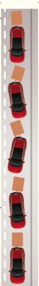
При буксировке система стабилизации прицепа (TSA) постоянно следит за движением прицепа по отношению к CR-V, корректируя его траекторию и не позволяя ситуации выйти из под контроля.
