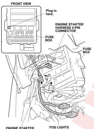
ENGINE STARTER HARNESS 4-PIN CONNECTOR
